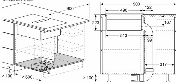
измерване в мм
