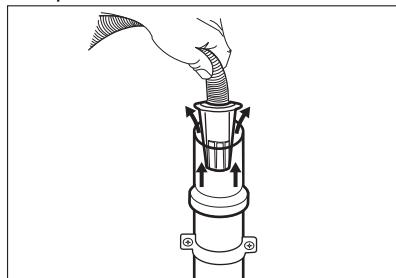
5. Без пластмасовия водач за маркуч, към канала на мивка – Поставете отводнителния маркуч в канала на мивката и го затегнете със скоба. Вижте илюстрацията.
